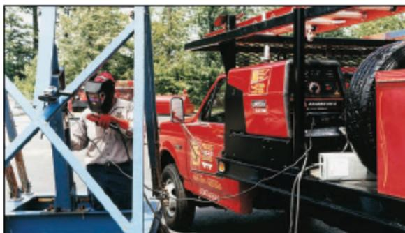
Haga de la Ranger<sup>®</sup> 305 G su estación portátil de soldadura: electrodo en general y tubería de descenso, Touch Start TIG<sup>®</sup>, MIG, alambre tubular y generador de CA para alimentar luces, amoladoras u otras herramientas eléctricas
